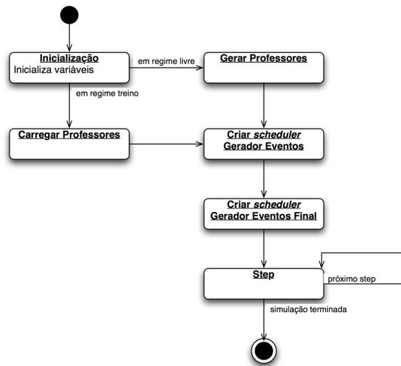
Figura 4.20: Diagrama de estados geral da simulação.
