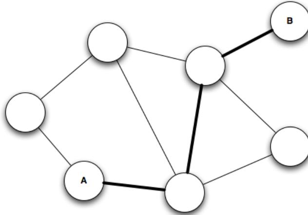
Figura 2.2: Caminho geodésico AB com distância geodésica 3.
